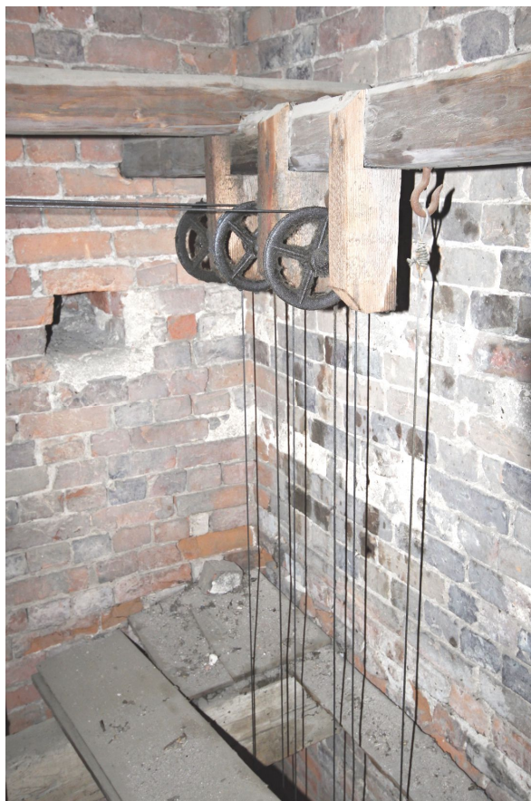
29. Závaží od mechanického hodinového stroje, který bude nahrazen strojem elektronickým.
